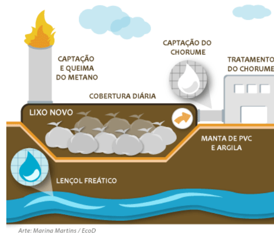
Figura 11: Ilustração esquemática de disposição de resíduos urbanos em aterros sanitários.
