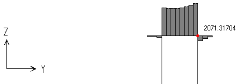
Figura 6-40 – Diagrama de Esforço Cortante – Eixo 35 – Projeto Executado
