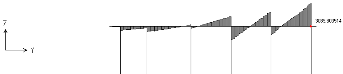
Figura 6-35 – Diagrama de Momento Fletor – Eixo 26 – Projeto Executado
