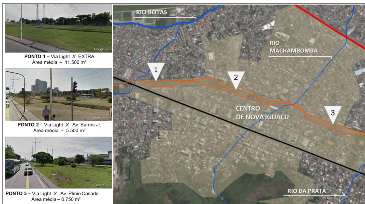
Figura 63: Proposta de localização, na Via Light (RJ-081), para reservatórios de retenção de água pluviais.
