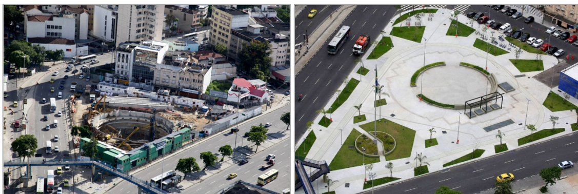
Figura 38: Exemplo de reservatório de detenção subterrâneo | Praça da Bandeira | Rio de Janeiro | RJ Fonte: Prefeitura do Rio de Janeiro, 2015.
