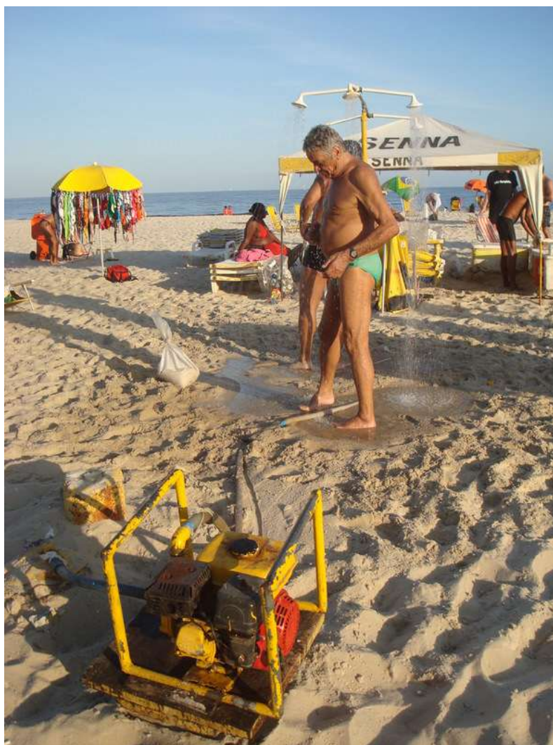
Figura 5.54: Tradicional ducha na praia utilizando motor a diesel para bombeamento da água.
