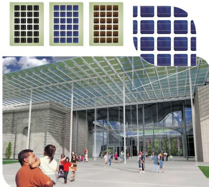
Figura 3.29: Exemplo de laminados de vidros fotovoltaicos. Fonte: SolarSafe
