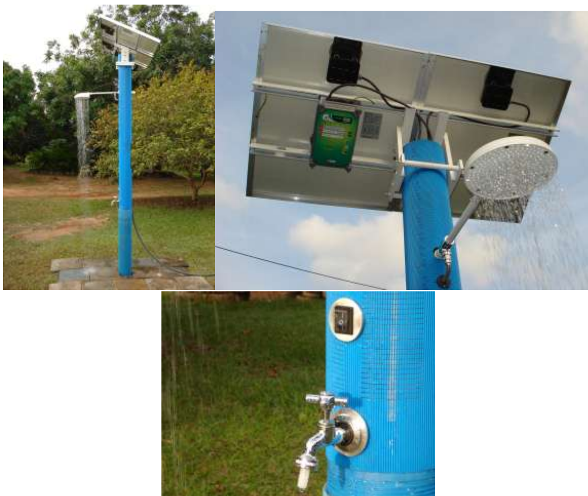
Figura 5.58: Protótipo da Ecoducha em teste. Fonte: arquivo particular, 2011.
