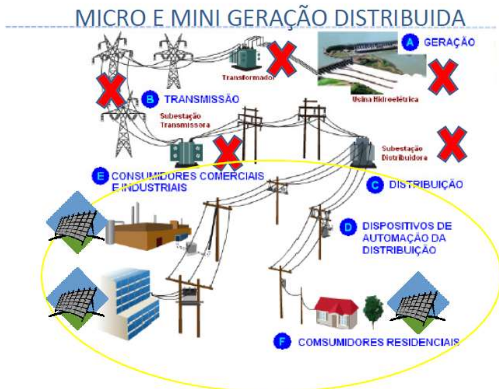
Figura 4.49: Esquema básico do caminho da geração de energia centralizada e de um pequeno circuito de geração distribuída com painéis fotovoltaicos.
