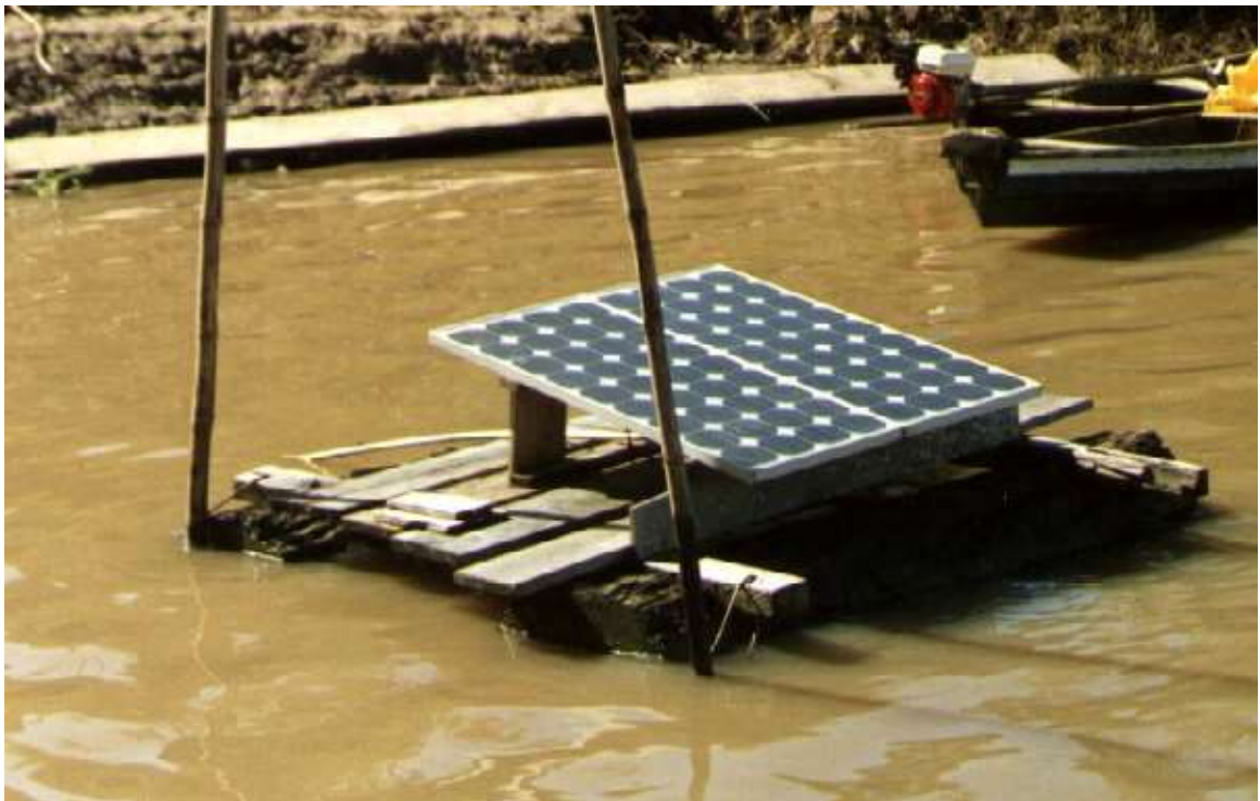
Figura 13: Sistema de bombeamento de água- Valente – Bahia. Fonte: USP-IEE, 2010.
