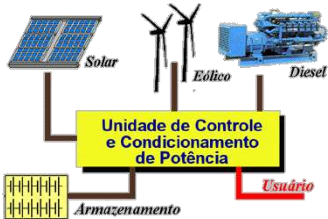
Figura 22: Exemplo de um sistema híbrido. Fonte: COELBA, 2010.
