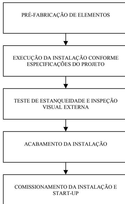
Figura 1. Estrutura funcional do processo de instalação para o gás LP. (Fonte: Autor)
