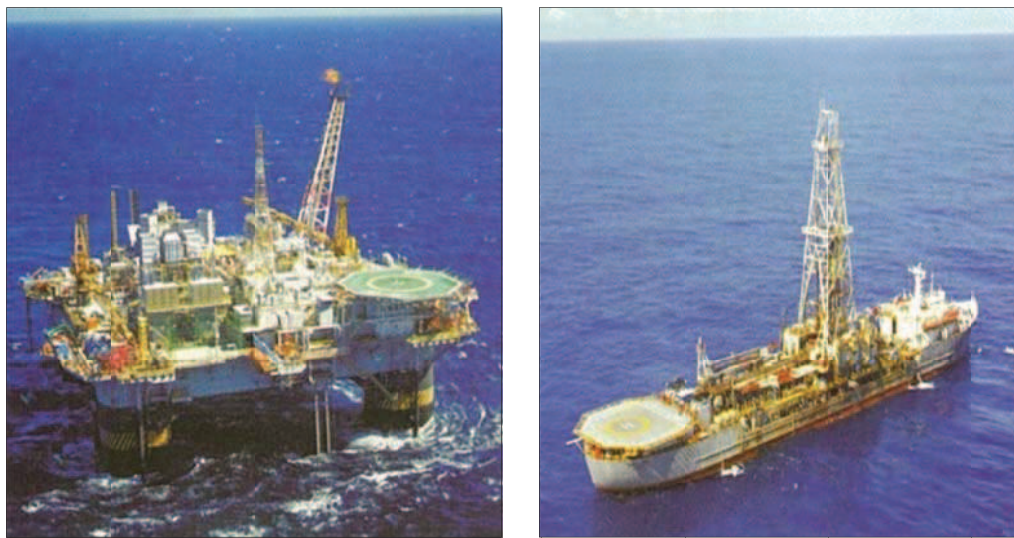
Figura 2.1: Sondas de perfuração semissubmersível (a) e navio-sonda (b). Fonte: Thomas (2004).
