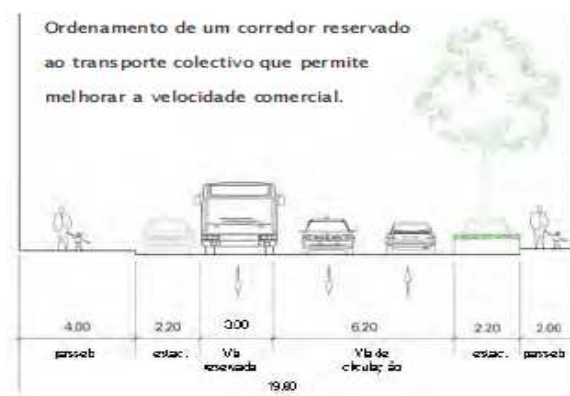
Figura 131 - Seção-tipo de um corredor de transportes
