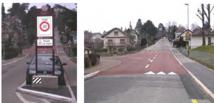
Figuras 120 e 121 - Medidas de moderação de tráfego em áreas residenciais
