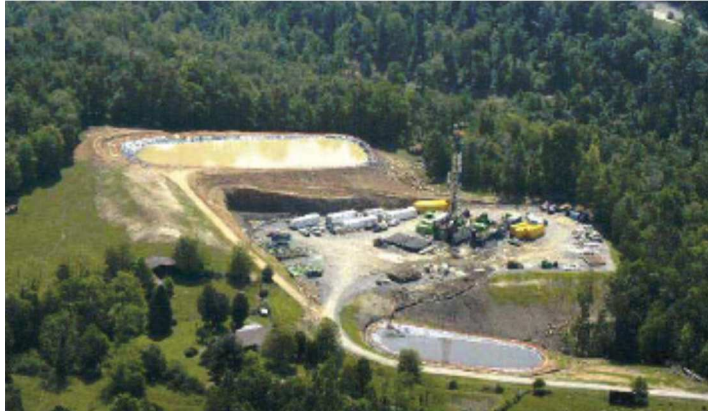
Figura 2.3: Locação durante a perfuração de poços de gás de folhelho, no município de Upshur, estado de West Virginia, nos Estados Unidos Fonte: Ground Water Protection Council; All Consulting, 2009
