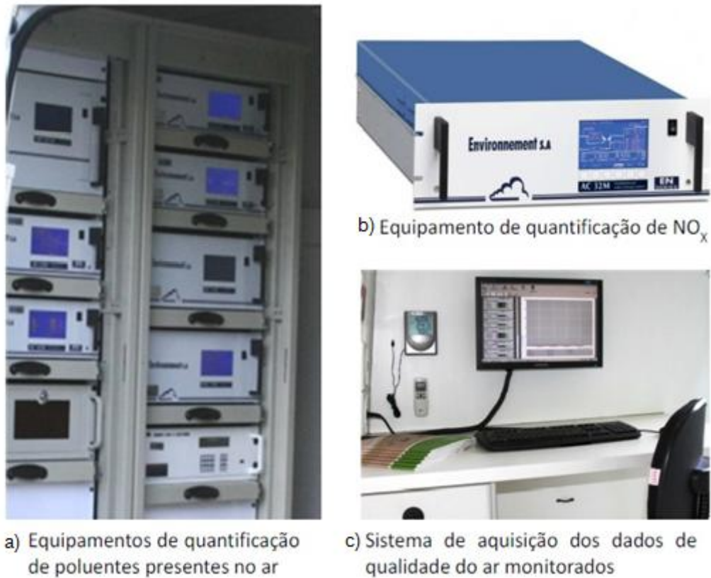
Figura 2: Equipamentos de quantificação de poluentes atmosféricos contidos nas estações automáticas de monitoramento da qualidade e meteorologia do ar do INEA. a) Equipamento de quantificação de poluentes presentes no ar, b) equipamento de quantificação de \text{NO}_x , c) sistema de aquisição dos dados de qualidade do ar monitorados.
