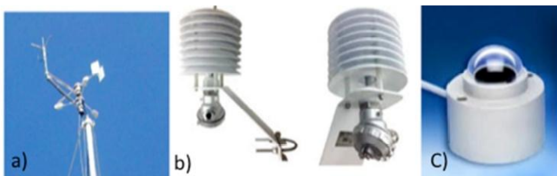
Figura 3: Sensores meteorológicos ambientais contidos nas estações automáticas de monitoramento do ar do INEA. a) Sensor de direção e velocidade de vento, b) sensor de temperatura e umidade relativa, c) sensor de radiação.
