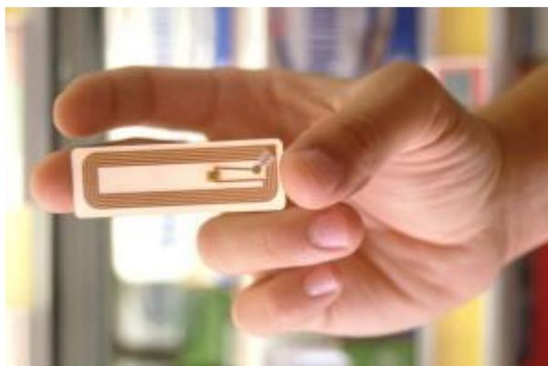
Figura 23 - Etiqueta RFID usada em produtos
