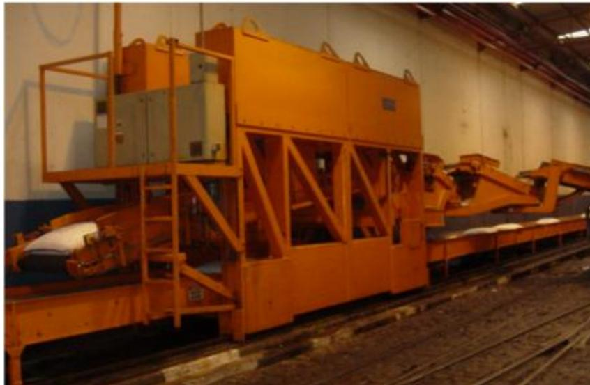
Figura 21 – Esteira de sacos de açúcar. Pesagem e paletização automática
