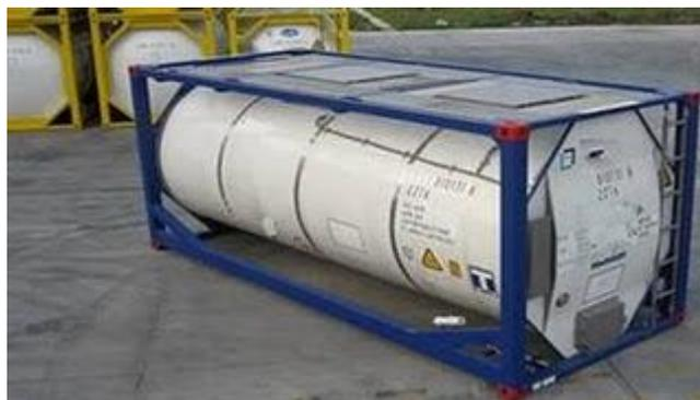
Figura 16 – Contêiner tipo *Tank*
