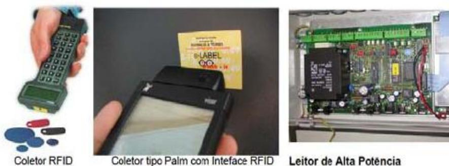
Figura 24 - Modelos de Transceiver (leitor)
