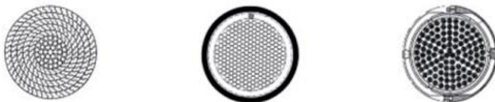
a) Cabos do tipo *Locked coil*   b) Cabos de fios paralelos   c) Cabos de cordoalhas paralelas
