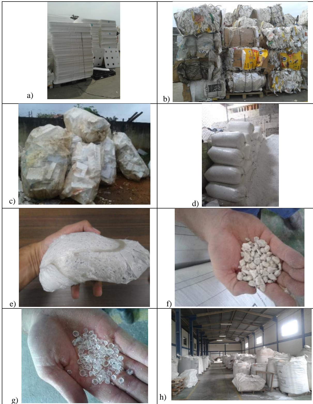
Figura 16. Fotos dos produtos processados de EPS pós-consumo: a) pranchas, b) prensado sob a forma de fardos, c) ensacado, d) triturado, e) reciclado compactado, f) reciclado granulado, g) reciclado peletizado, h) big bags de EPS reciclado granulado e peletizado.
