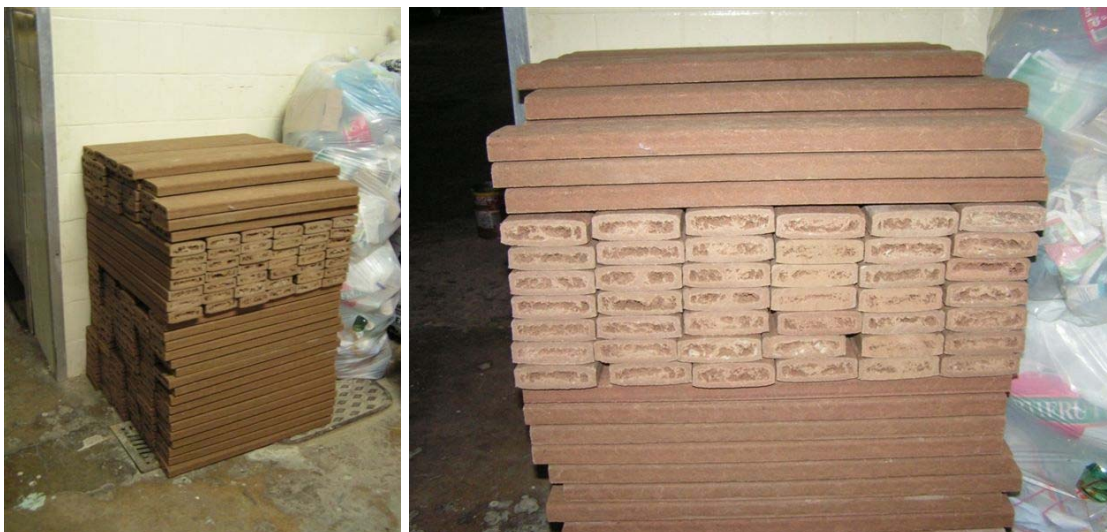
Figura 16 – Ecoproduto Madeira Plástica: Primeiro lote com defeito de fabricação (Fotografia: Othon de Castro, 2010)
