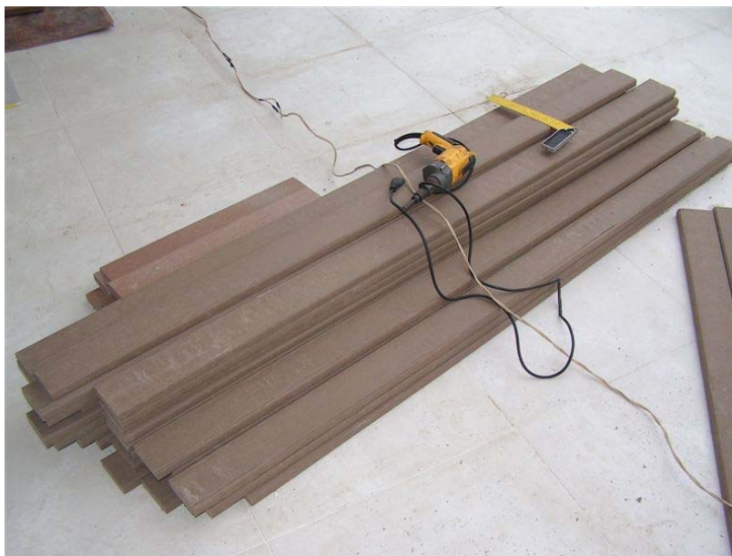
Figura 17 – Ecoproduto Madeira Plástica: Lote regularizado entregue em varas (Fotografia: Othon de Castro, 2010)
