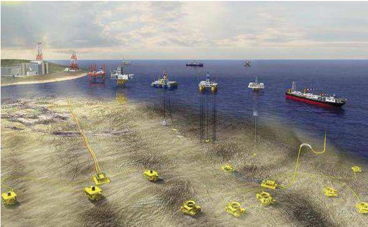
Figura 3.9 – Tipos de plataforma marítima de produção de petróleo
