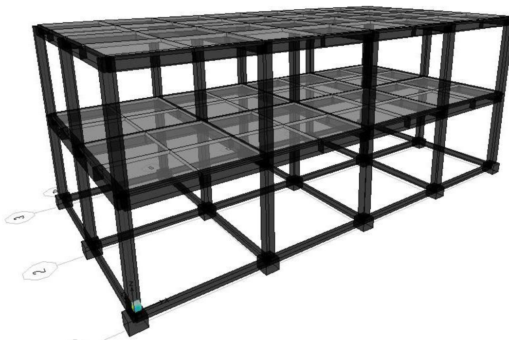
Figura 3.9 – Vista tridimensional do modelo da edificação administrativa (SAP2000, 2016).
