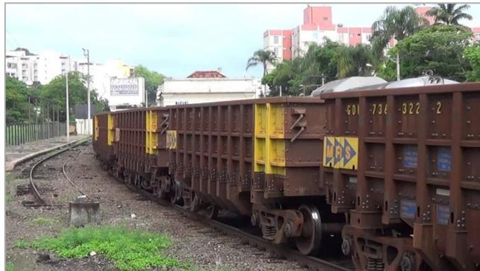
Figura 7 - Vagão GDU – peso bruto de 1400 kN ou 350 kN/eixo.
