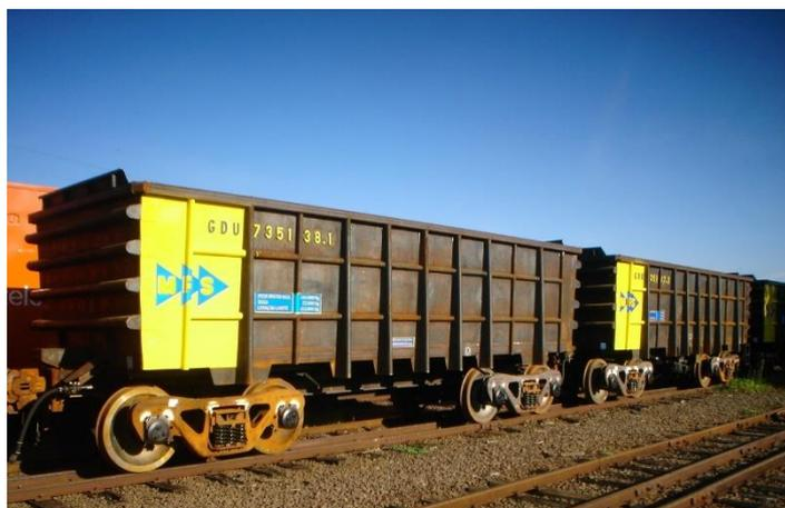
Figura 6- Vagão GDT - peso bruto de 1200kN ou 300kN/eixo.
