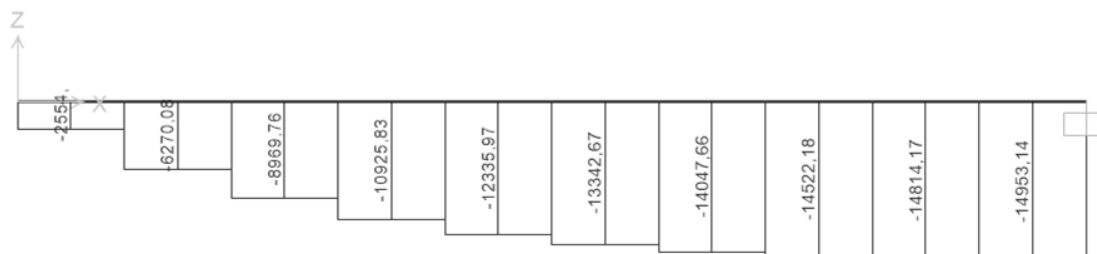
Figura 4.21 - Diagrama de esforço normal de barra engastada com molas 1.
