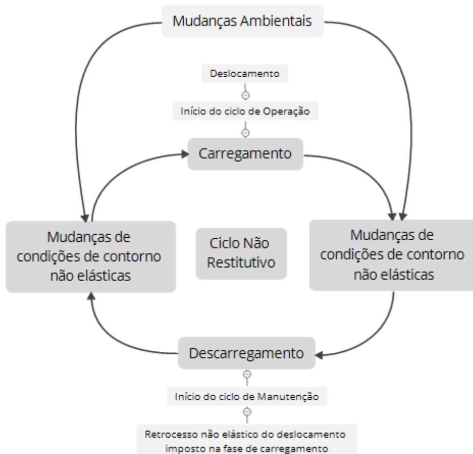
Figura 5.8 - Esquema gráfico de ação cíclica de carregamento de dutos.
