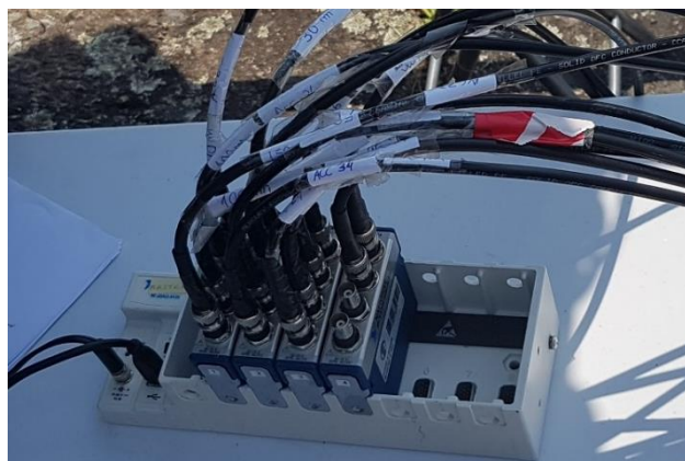
Figura 4-1 – Sistema de aquisição de dados cDAQ-9172 e módulos NI 9234
