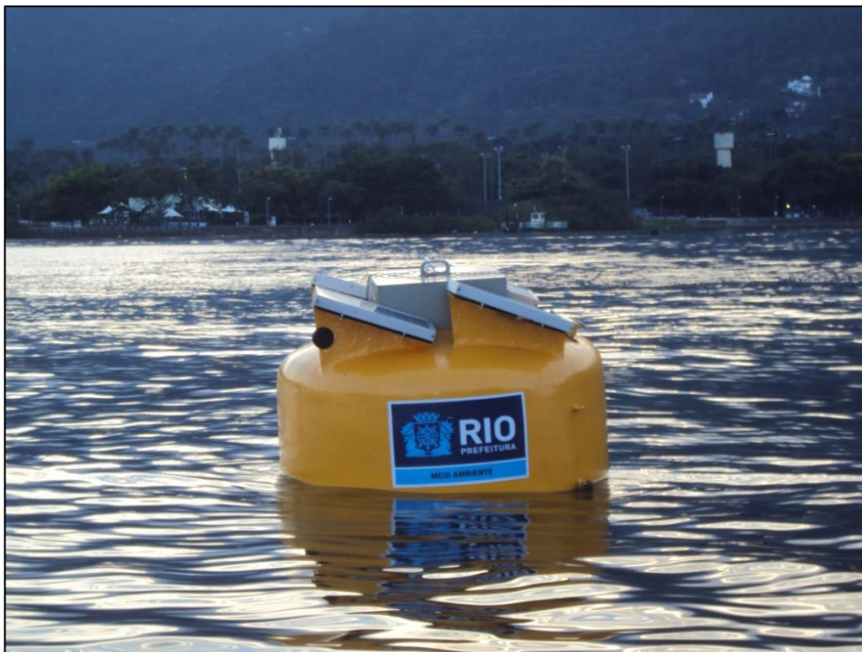
Figura 7a - Boia contendo sonda multiparamétrica. Fonte: Foto cedida pela empresa TECMA em 2017.
