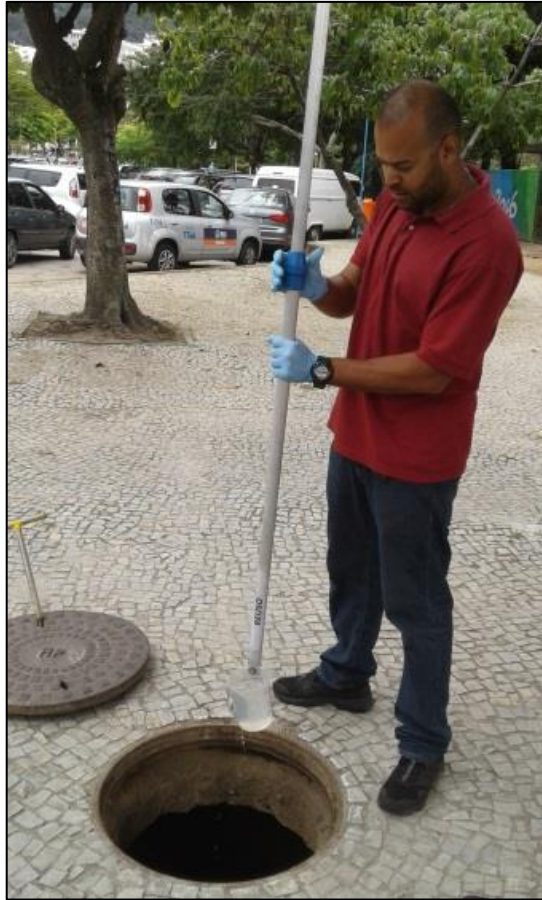
Figura 43b - PV de avaliação residual a jusante do recebimento do produto, relacionado ao ponto de deságue de número 2. Foto cedida pela CMA da SMAC em 2017.
