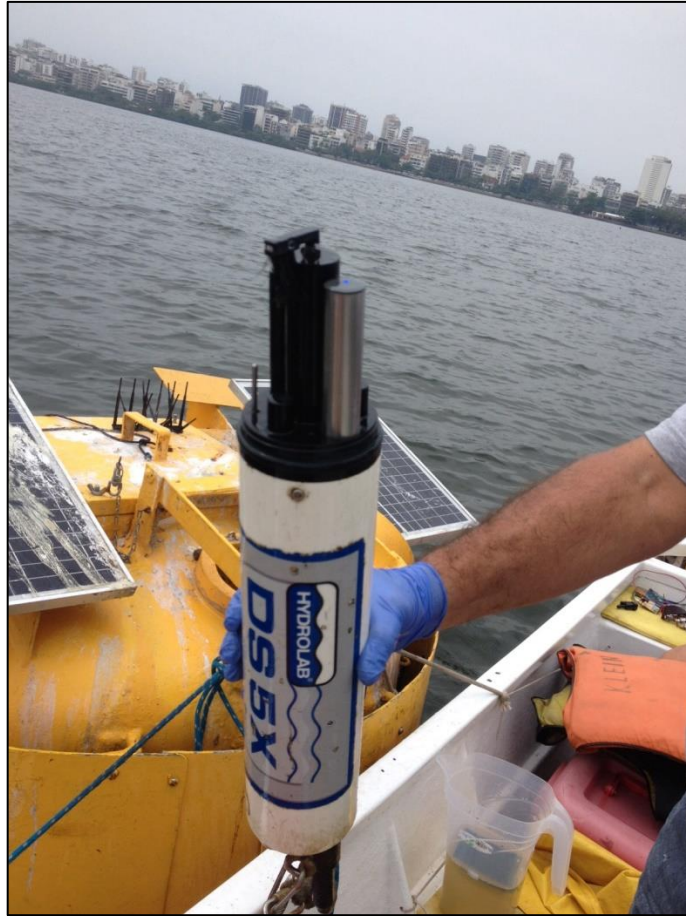
Figura 7b - Sonda multiparamétrica envolvida no monitoramento contínuo. Fonte: Foto cedida pela empresa TECMA em 2017.
