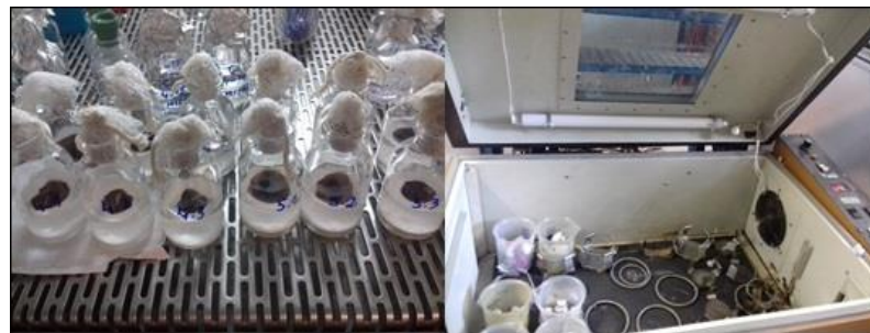
Figura 19 - Demonstração do ensaio de biodegradação de óleo combustível: à esquerda os sistemas aquáticos artificiais preparados e à direita os sistemas prontos para agitação.
