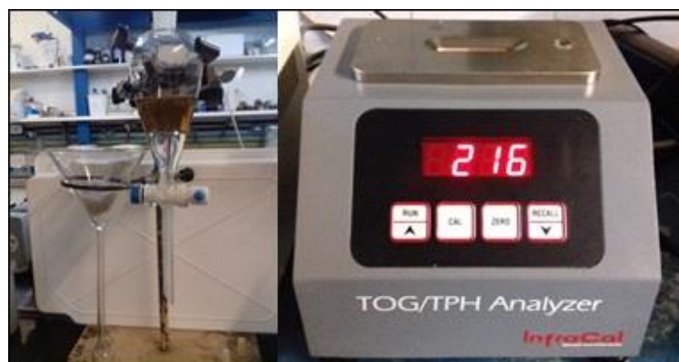
Figura 20 - À esquerda: Extração de óleo do ensaio de biodegradação. À direita: Aparelho de infravermelho para quantificação de hidrocarbonetos
