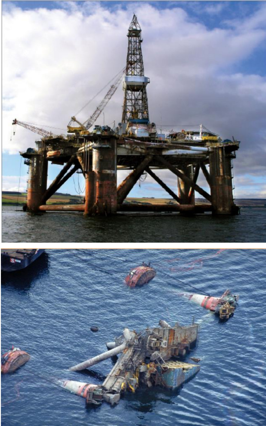
Figura 1.2 – Plataforma Alexander Kielland antes e depois do acidente (FERREIRA, 2013)
