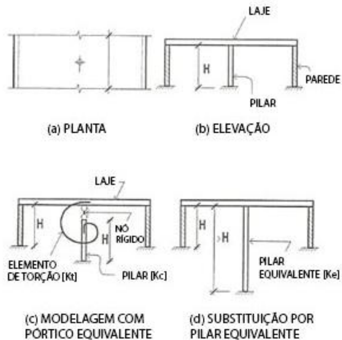
Figura 8 - Esquema para determinação do pilar equivalente (Adaptado de AALAMI & BOMMER, 1999).
