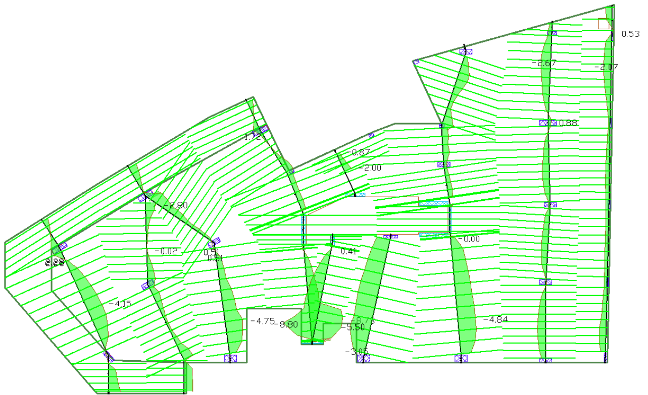
Figura 84 - ELS - Combinação frequente: tensões normais (MPa) nas fibras superiores (direção vertical) (FLOOR-PRO)
