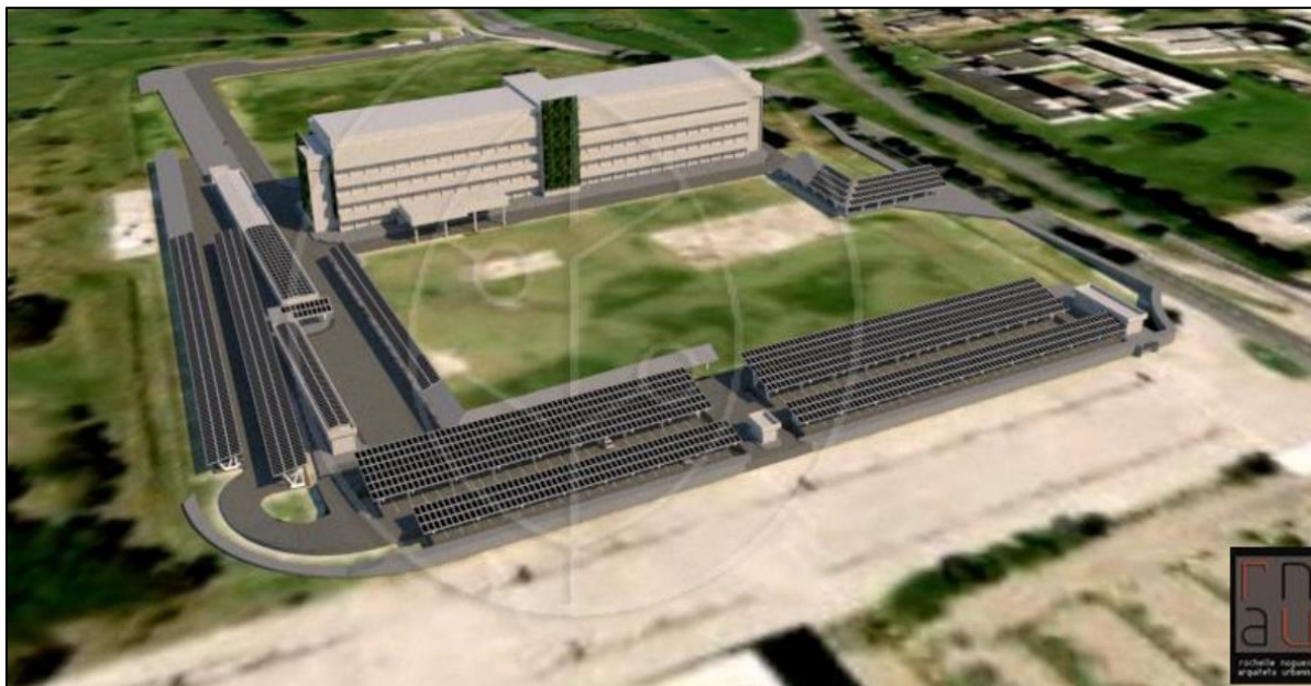
Figura 27 – Vista dos painéis solares em estacionamentos e coberturas
