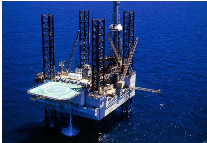
Figura 6 Plataforma Auto-Elevatória P-5 operando no litoral do Rio Grande do Norte Fonte: PETROBRAS, 2017.
