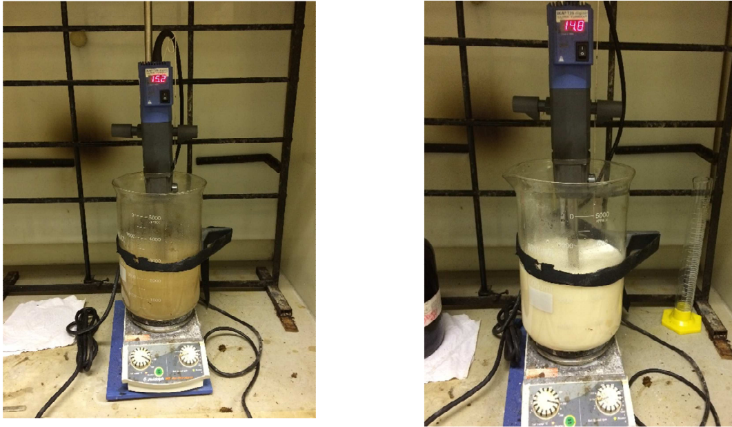
Figura 3-1: Sistema para preparo das emulsões. A esquerda: viscosificante e a direita, tensoativo.
