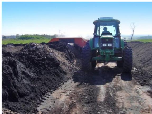
Figura 17: Instrumento acoplado a um trator simples, para auxílio na formação das leiras.
