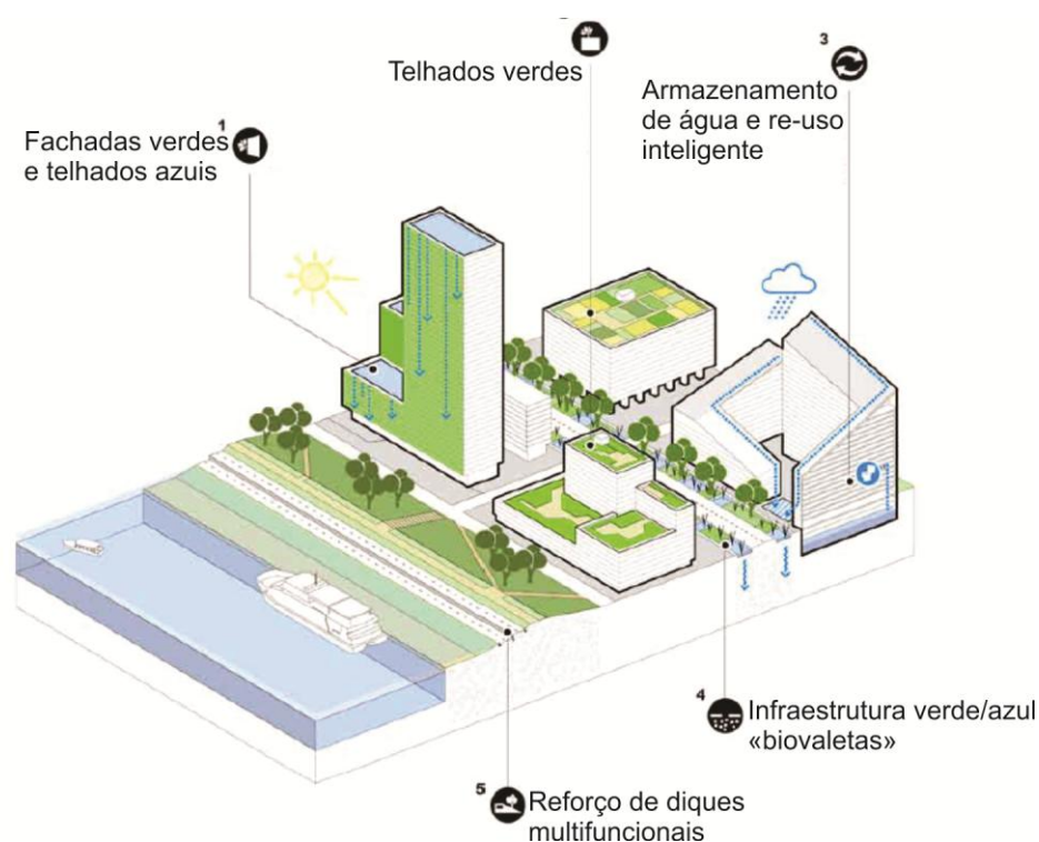
Figura 10. Medidas de adaptação para edificações com abordagem IV e IA na Estratégia de Adaptação da Cidade de Roterdã. Fonte: EAR, 2013, tradução nossa, 2017.
