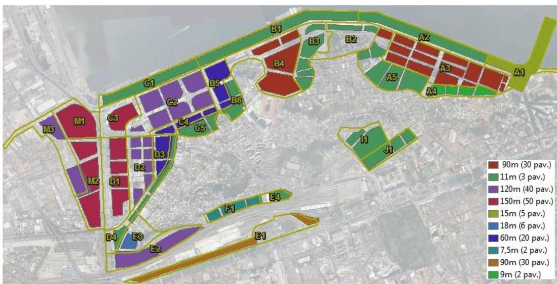
Figura 24 – Gabarito máximo por subsetor.
