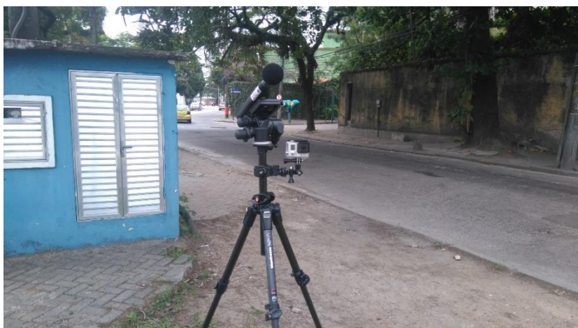
Figura 44 - Medidor de pressão sonora e câmera para filmagem de tráfego
