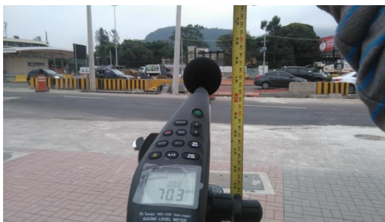
Figura 47 - Altura do microfone do medidor em relação ao solo.
