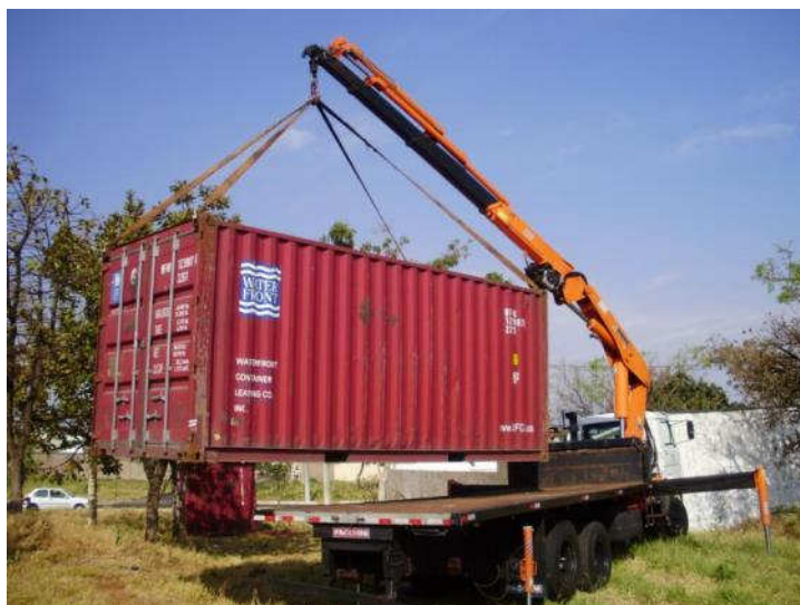
Figura 20: Caminhão tipo Munck entregando contêiner em terreno
