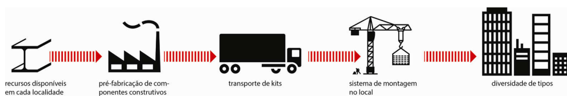
Figura 9: Imagem esquemática do processo construtivo sugerido (TOLEDO, 2015).
