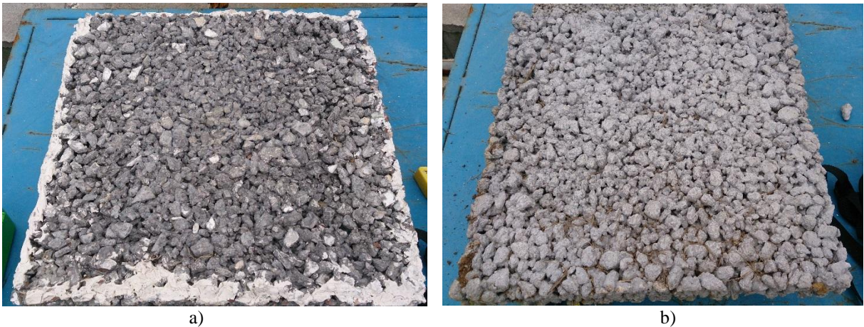
Figura 19 – placa de pavimento permeável (2015) a) 100% AGC e b) 50% AGC e 50% AGD
