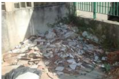
Figura 5 – Piso Cerâmico – Resíduo de construção Vidal, 2014
