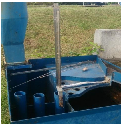
Figura 21 – Caixa pluviométrica com aparato medidor (equipamento registrador) (2017)
