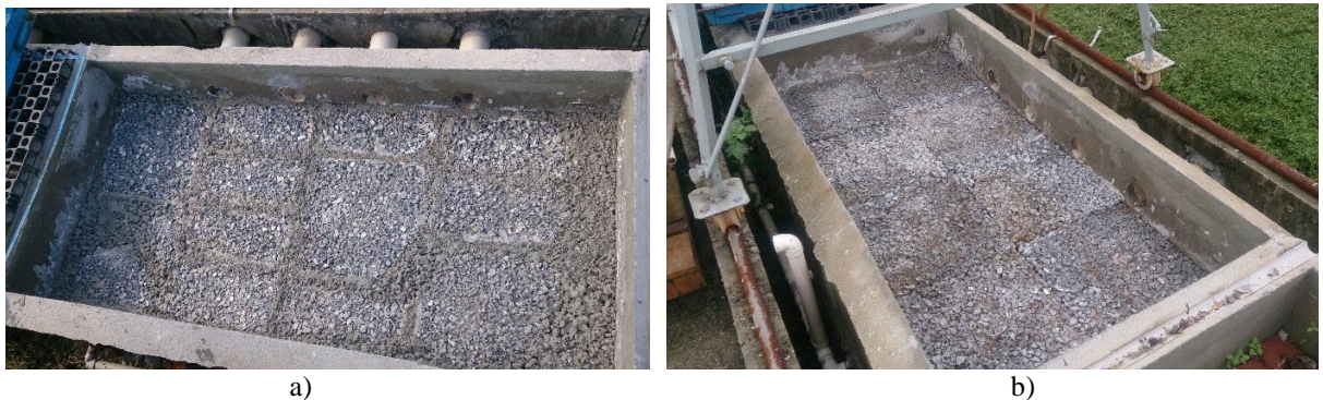
Figura 20 – placas montadas na bancada para ensaio (2017) a) 100% AGC e b) 50% AGC e 50% AGD
