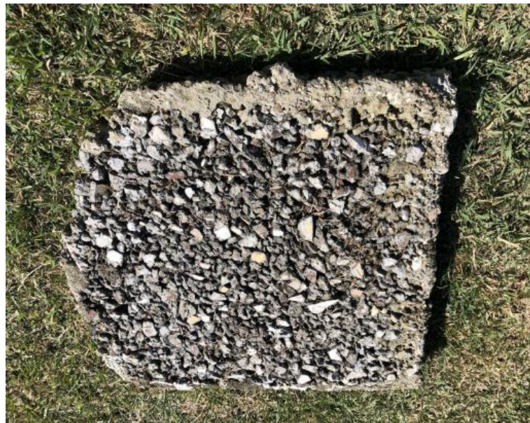
Figura 35 – Placa 100% de agregado graúdo de resíduo de construção – AGC (2015)
