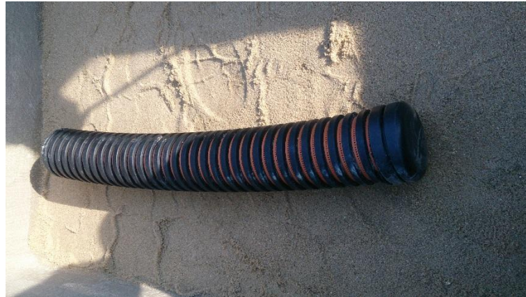
Figura 12 – Tubo de drenagem flexível perfurado (2015)
