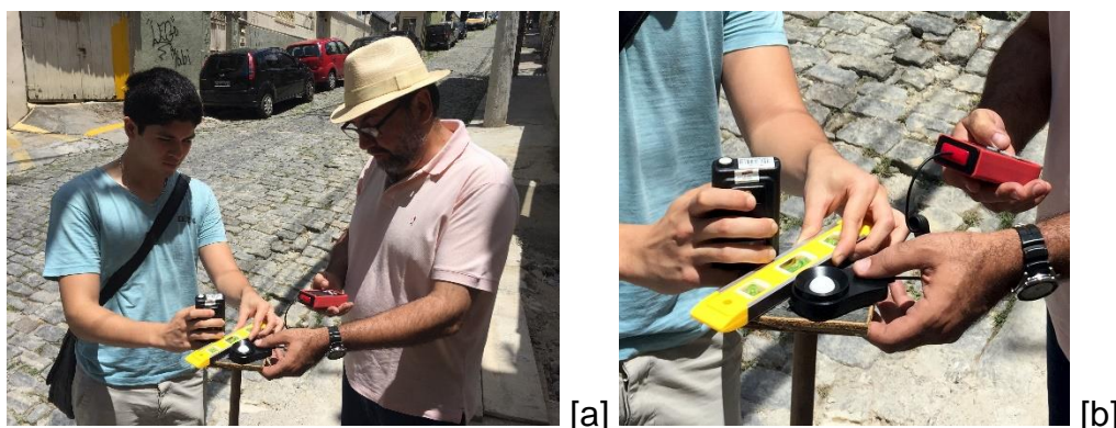
Figura 52 – Utilização dos equipamentos e nivelamento da plataforma durante uma rodada de medições na Rua João Afonso (Fotos [a] e [b]: Elaine Vazquez).
