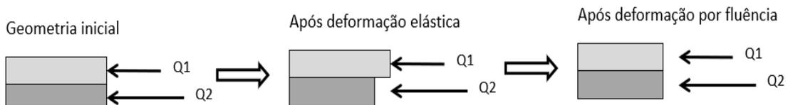
Figura 24 – Compatibilização da deformação de fibras adjacentes devida à fluência (CAMARA, 2001).
