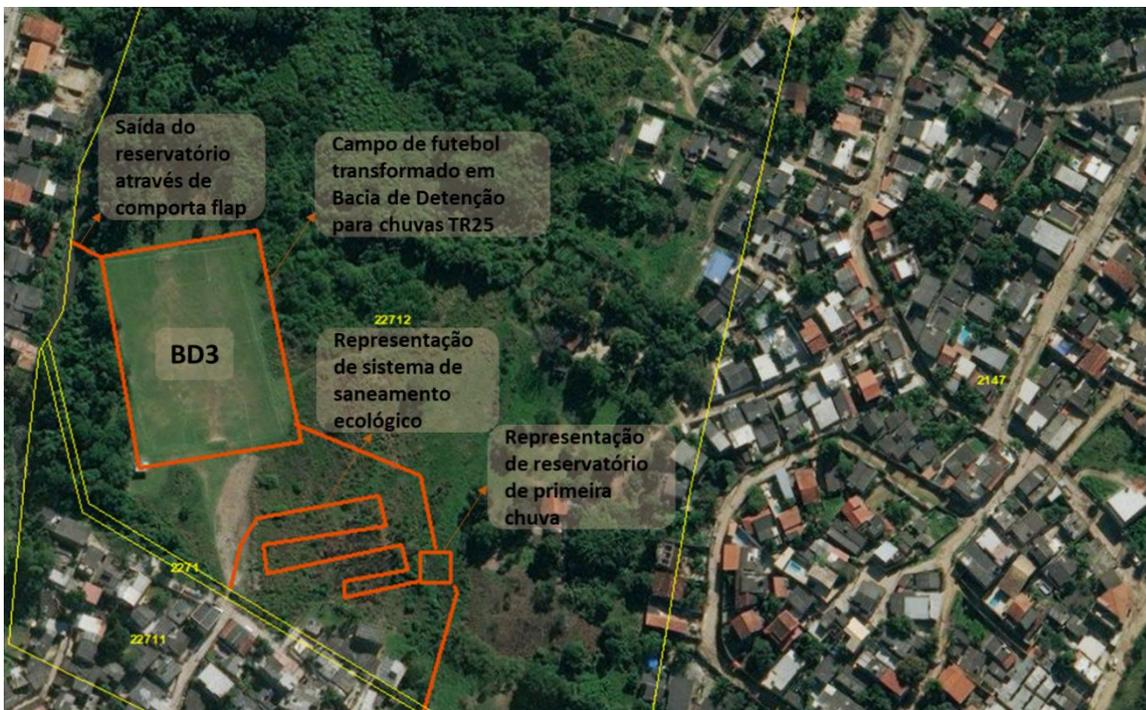
Figura 71 - Bacia de Detenção (BD3) *off line* a jusante do trecho canalizado, na região escolhida para Estudo de Caso
