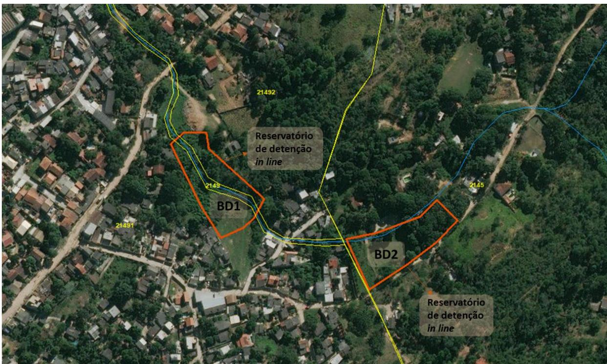
Figura 69 - Bacias de Detenção *in line* a Montante – São Gonçalo/RJ
