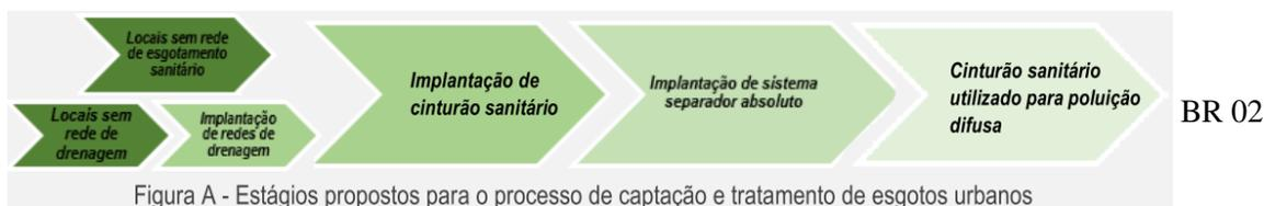
Figura A - Estágios propostos para o processo de captação e tratamento de esgotos urbanos
