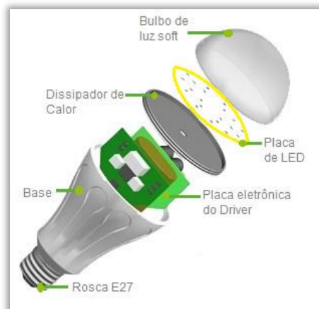
Figura 28 Esquema dos componentes das lâmpadas LED tipo bulbo.
