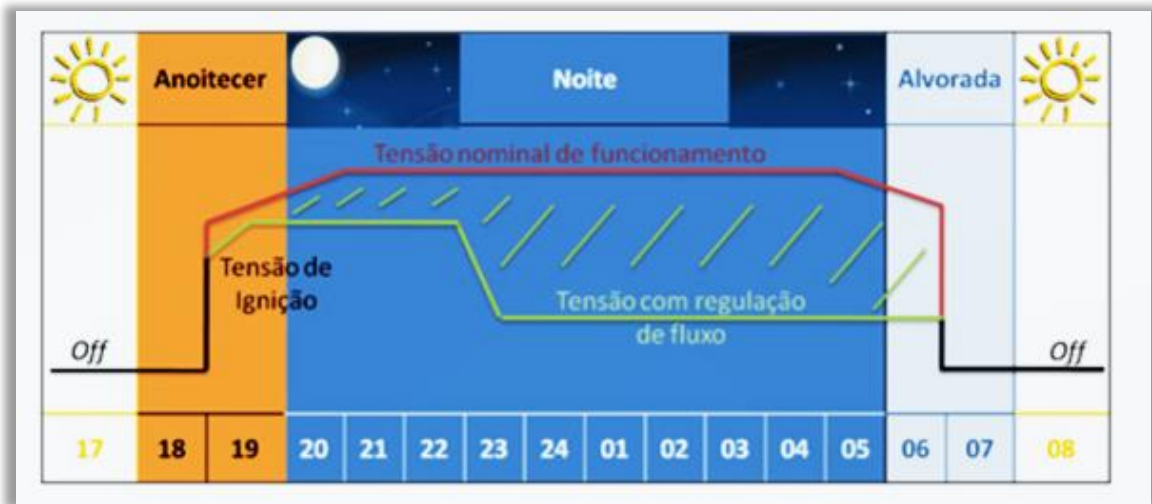
Gráfico 12 Exemplo de funcionamento de um Regulador de Fluxo ao longo do período noturno
