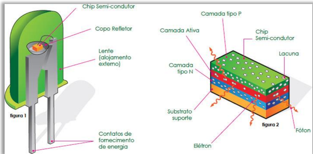
Figura 25 Esquema Estrutural do LED e funcionamento do Chip Semicondutor
