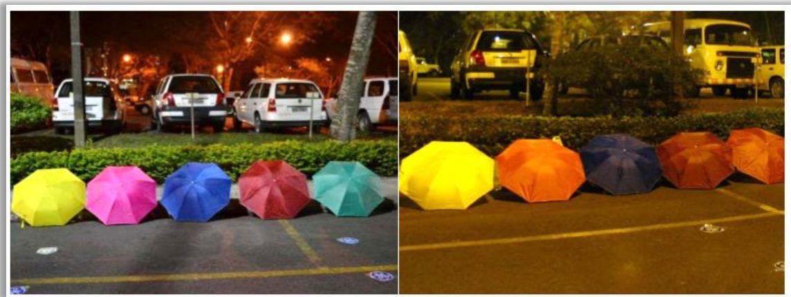
Figura 9 Comparativo entre duas fontes luminosas com diferentes IRCs
