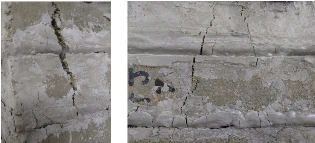
Figura 42: Ruptura típica dos prismas sob compressão. Fonte: Arquivo pessoal.
