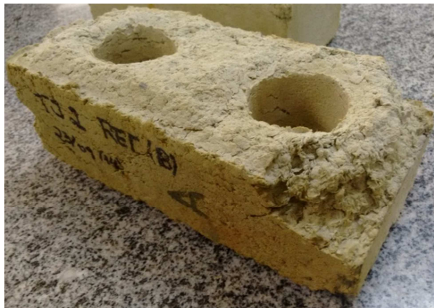
Figura 45: Desagregação do tijolo T2b após o ensaio de durabilidade. Fonte: Arquivo pessoal.
