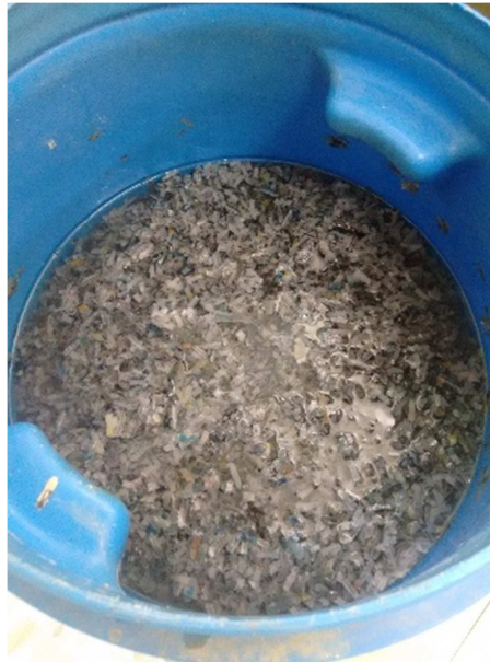
Figura 130: Papel imprensa fragmentado imerso em tonel com água. Fonte: Arquivo pessoal.
