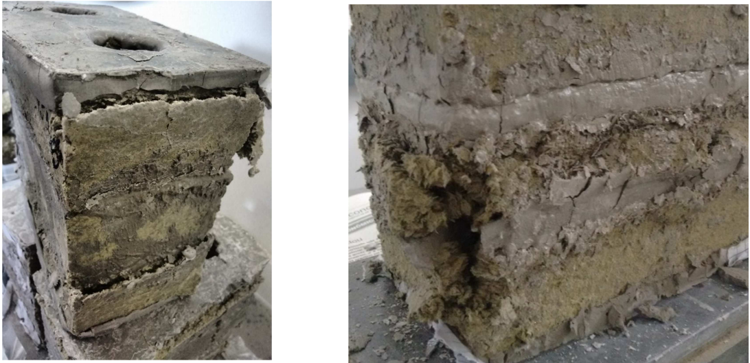
Figura 43: Destacamento de face dos prismas do tipo T2. Fonte: Arquivo pessoal.
