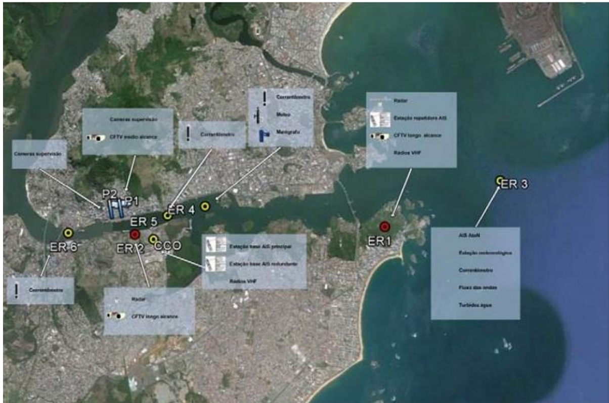
Figura 19 - Vista da distribuição das estações remotas dentro da área do VTMS. Fonte: CODESA
