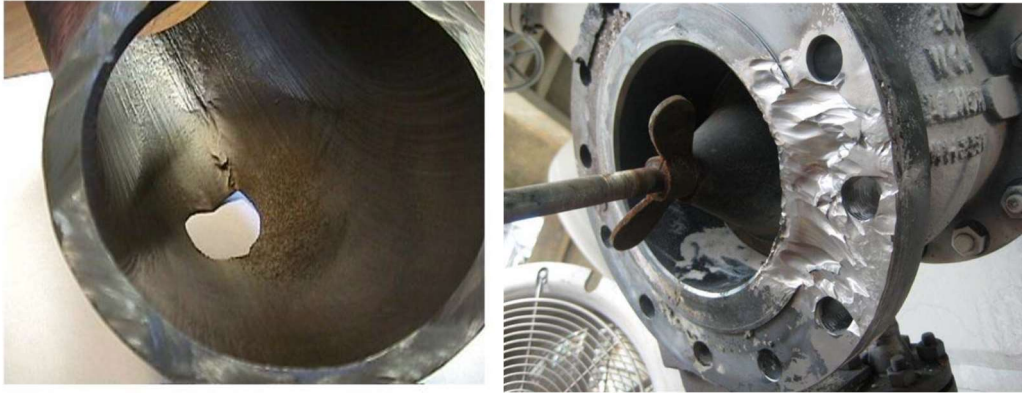
Figura 8: Exemplos de danos causados por erosão-corrosão. (a) Erosão de um aquecedor (9Cr-1Mo); (b) Erosão-corrosão de um flange de uma válvula de um catalisador (1.25Cr 300 #). (source: API 571).
