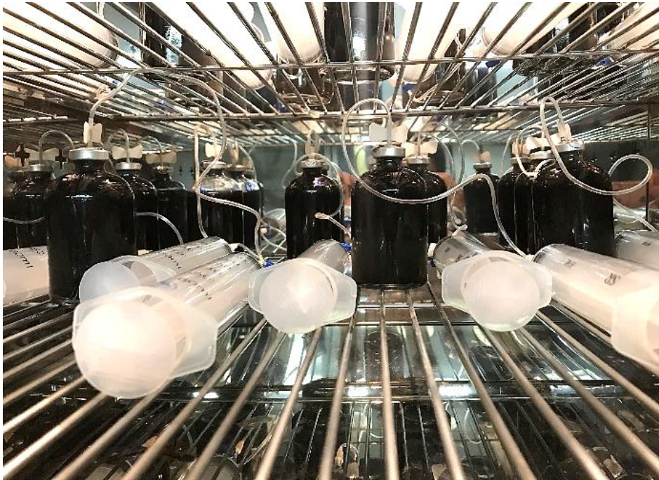
Figura 12- Frascos penicilina com seringa acoplada para quantificação do biogás produzido. Fonte: Fotografia por T.M.S.Castro em Dezembro/2017
