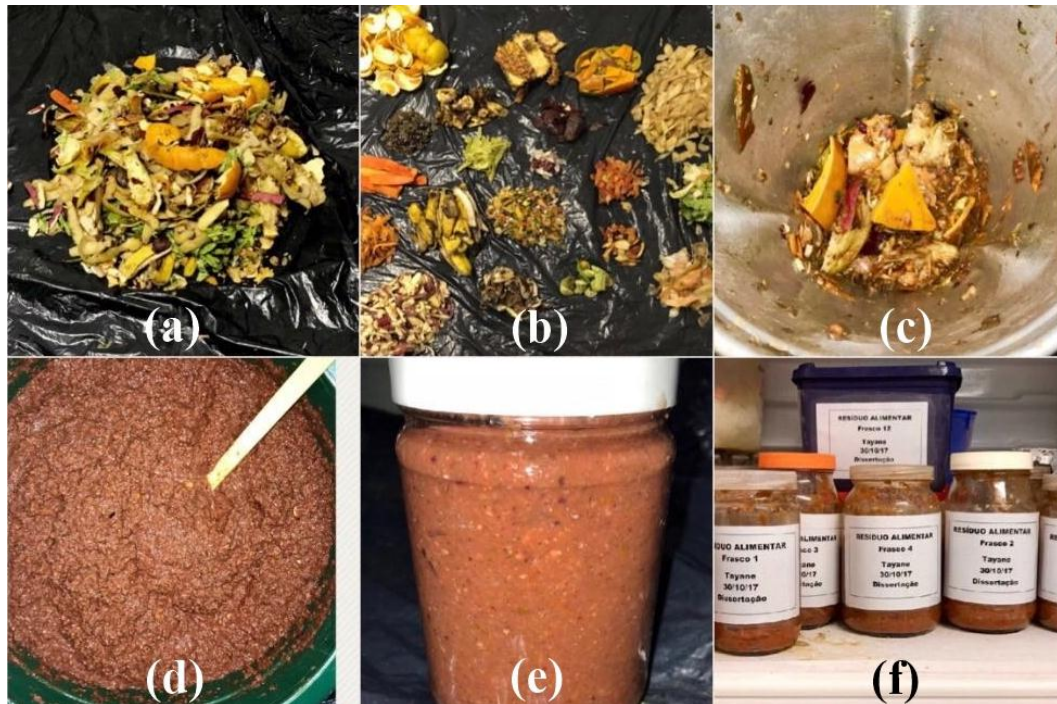
Figura 13- Etapas de obtenção do resíduo alimentar: (a) Resíduo orgânico alimentar domiciliar recebido no laboratório; (b) resíduo segregado manualmente; (c) trituração do resíduo; (d) resíduo alimentar obtido após trituração; (e) e (f) resíduo alimentar para armazenamento.
