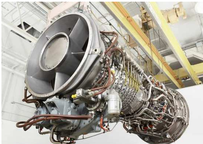
Figura 12 – Turbogenerador típico utilizado em uma plataforma do tipo FPSO.
