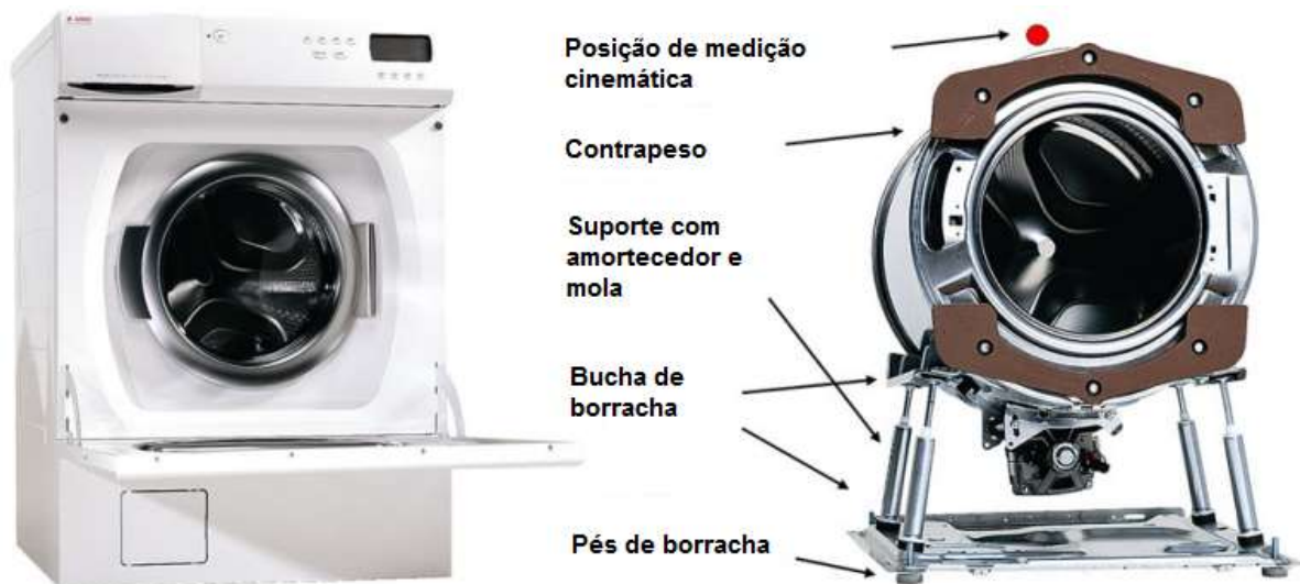
Figura 26 – Estrutura interna de uma máquina de lavar
