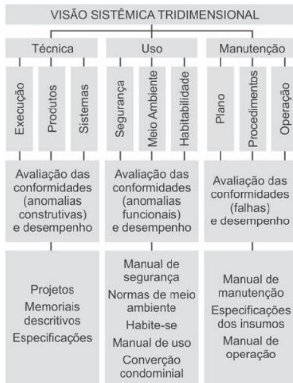
Figura 10 - Esquema da visão Sistêmica Tridimensional para Inspeção Predial GOMIDE; PUJADAS; FAGUNDES NETO, (2006)
