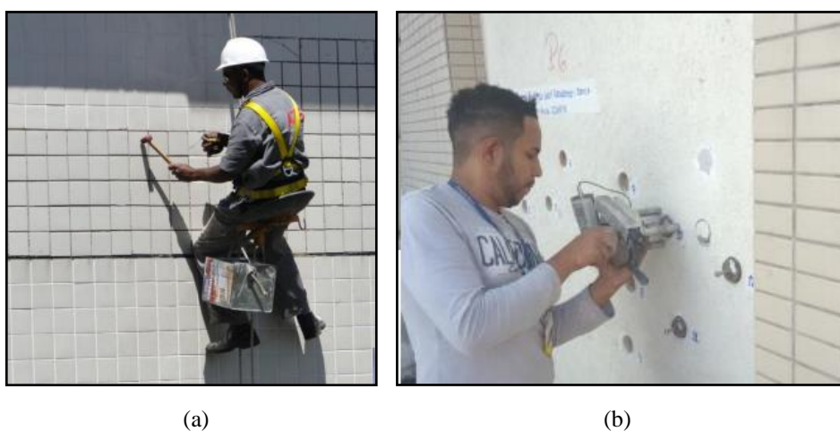
Figura 18 - (a) Teste de Percussão (b) Teste de arrancamento
