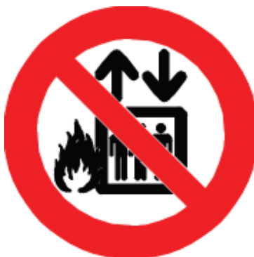
Figura 27: Proibição de uso de elevadores em caso de incêndio (Código 4)
