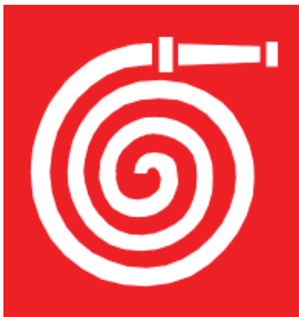
Figura 30: Sinalização abrigo de mangueira e hidrante (Código 25)
