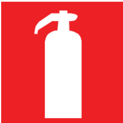
Figura 29: Sinalização extintor de incêndio (Código 23)
