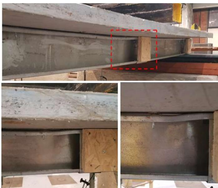
Figura 59 - Ensaio 01: Flambagem local próximo ao ponto de aplicação de carga
