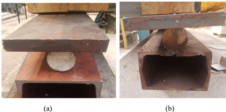
Figura 48 – Tipos de apoio: (a) Apoio móvel; (b) Apoio fixo
