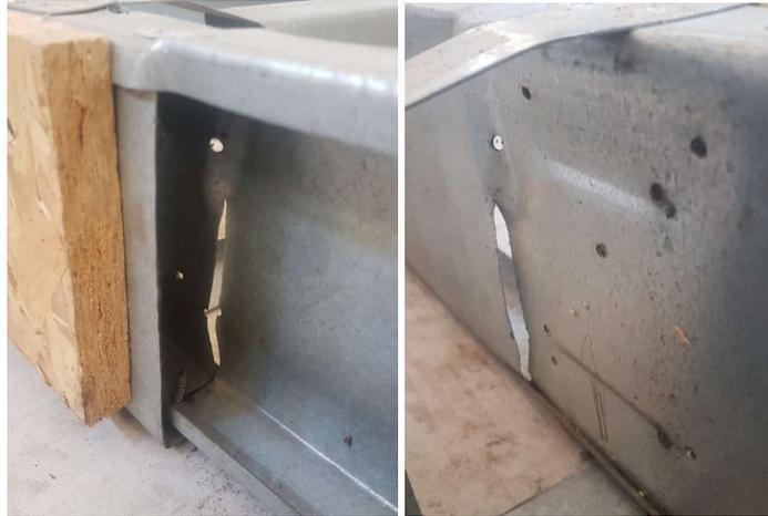
Figura 61- Ensaio 2: Ruptura do trecho tracionado do perfil metálico
