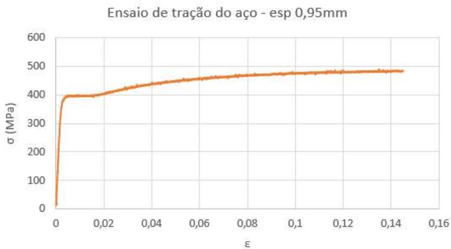
Figura 33- Curva tensão-deformação do ensaio de tração CP 01
