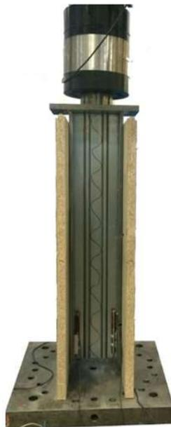
Figura 18 - Modelos de ensaio *Push-out* de KYVELOU (Adaptado de KYVELOU, 2017)
