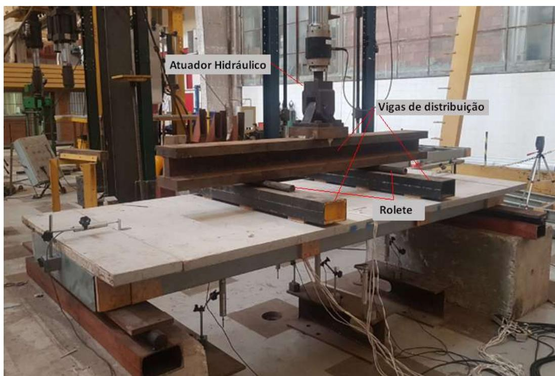
Figura 49 – Vista geral do ensaio com o sistema de aplicação de carga
