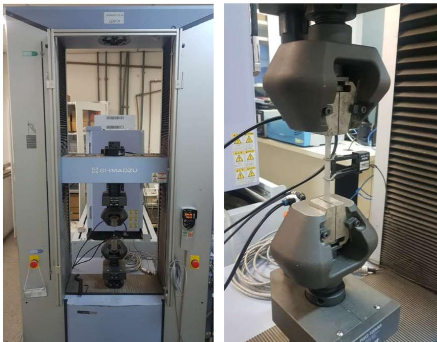
Figura 31 - Ensaio de tração direta para caracterização do aço
