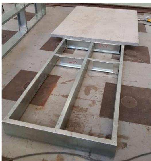
Figura 57- Quarto ensaio - não realizado - com metade da placa aparafusada aos perfis e a junta posicionada no meio do vão
