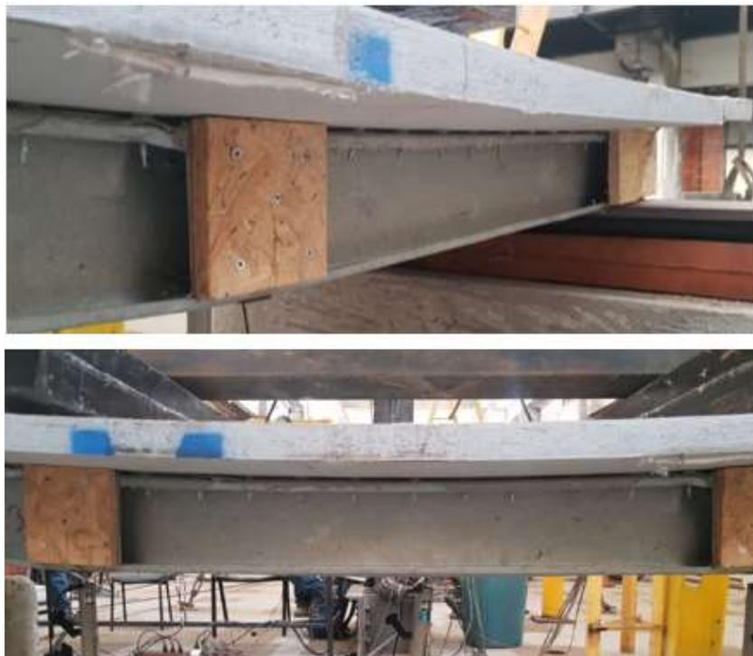
Figura 62- Ensaio 03: efeito de *curling* na mesa inferior dos perfis
