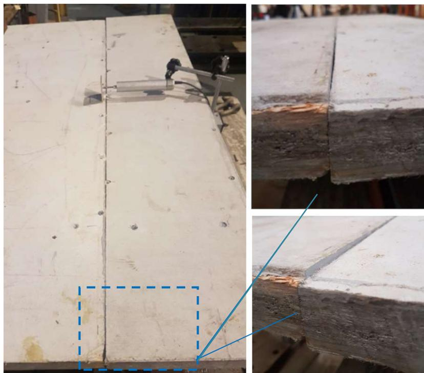
Figura 63 – Ensaio 2: Fechamento das juntas entre placas.
