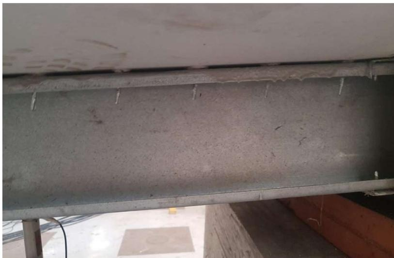
Figura 68- Ensaio 03: Inclinação dos parafusos próximos ao apoio.
