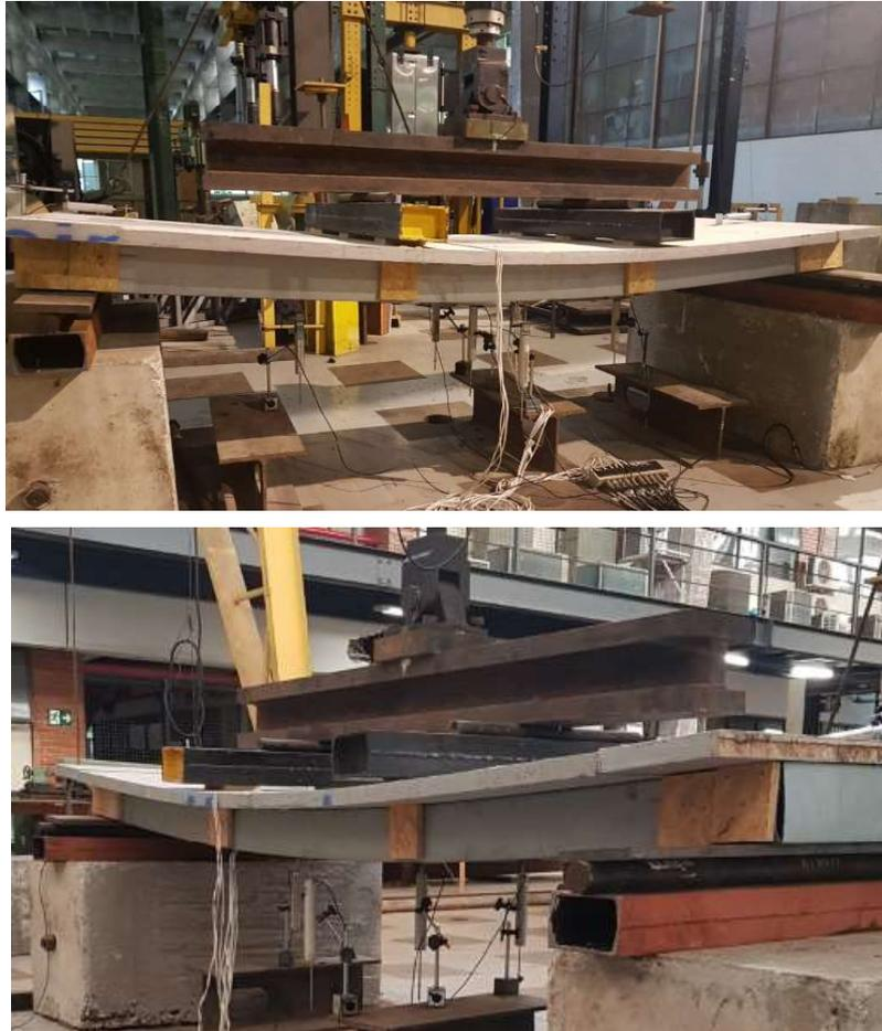
Figura 60 – Vistas do piso misto deformado ao final dos ensaios
