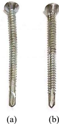
Figura 66 – Parafusos retirados após o ensaio, em diferentes posições do sistema de piso: (a) nos extremos; (b) no centro.
