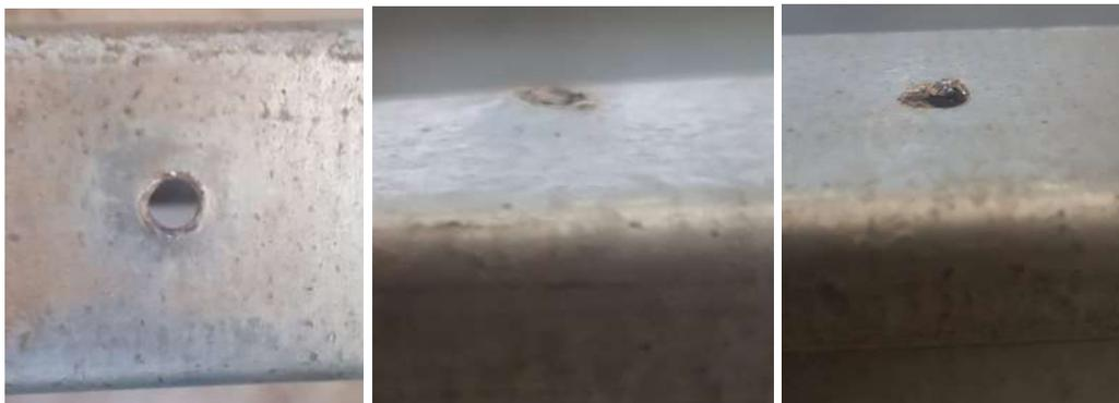
Figura 67 – Ensaio 2: Furos levemente alargados e puxados para cima com o aumento do grau de interação entre os elementos
