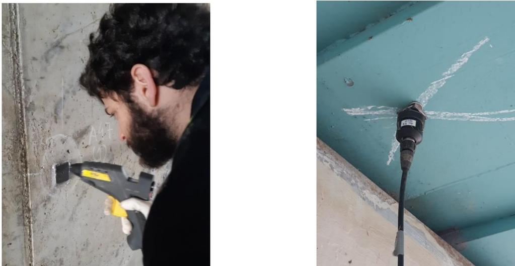
Figura 2.17 – Fixação dos acelerómetros por intermédio de: a) chapas coladas b) chapas magnéticas.
