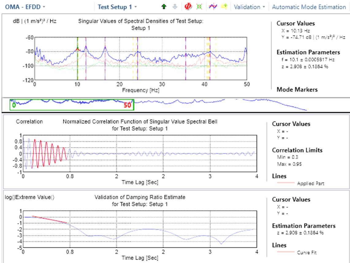
Figura 3.19 – Identificação do amortecimento do primeiro modo experimental
