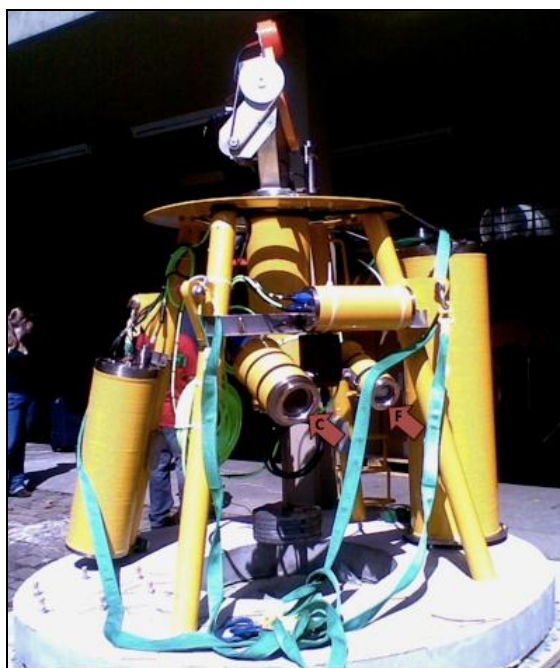
Figura 30 - Lander . As setas em vermelho indicam a localização da time lapse câmera e de seu flash para monitoramento visual.
