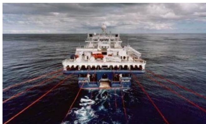
Figura 8 - Reboque de cabos sísmicos. Fonte: CAPANEMA & QUEIROZ (2009).
