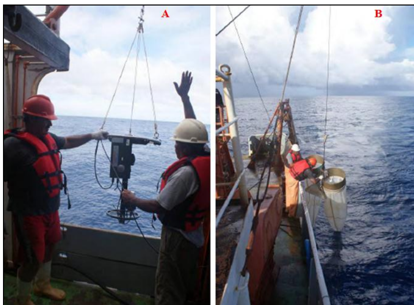
Figura 27 - Lançamento do LOPC/Micro CTD (A) e das redes cilíndrico-cônicas (B) na 1ª Campanha oceanográfica ( Baseline ) para avaliação das comunidades planctônicas.
