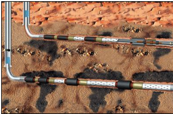
Figura 18 - Perfuração Horizontal. Fonte: TAM (2011).
