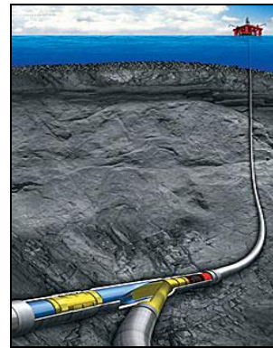
Figura 19 - Perfuração Horizontal. Fonte: STATOIL (2011).
