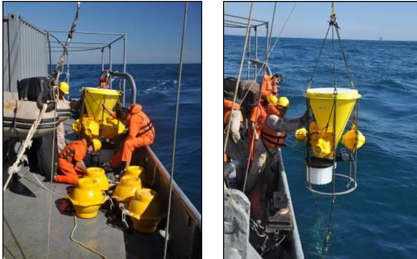
Figura 33 - Sediment trap no momento de sua instalação no Campo de Peregrino. Fonte: STATOIL (2011).
