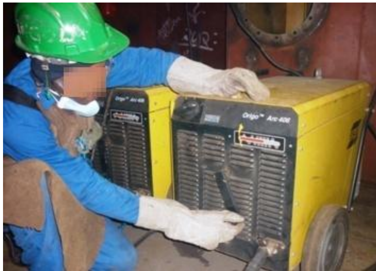
Foto 59 – Regulagem da máquina de solda. Fonte: o autor.
