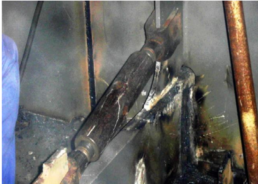
Foto 13 – Esticador fixando e alinhando o bloco.
