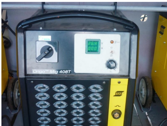
Foto 58 – Máquina de solda de eletrodo com luzes de sinalização e chave seletora. Fonte: o autor.
