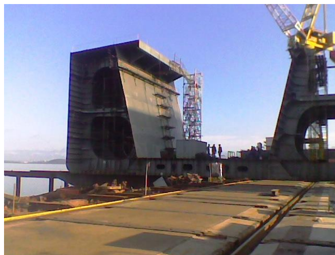
Foto 9 – Anel sendo movimentado para carreira de lançamento. Fonte: o autor.
