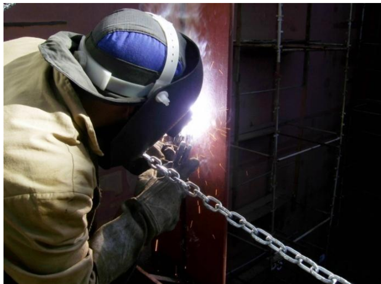
Foto 29 – Soldagem de suporte da corrente. Fonte: o autor.
