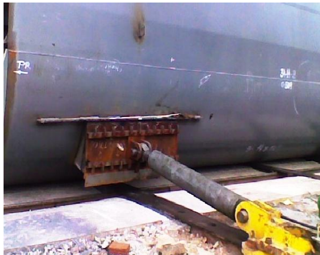
Foto 8 – Dispositivo de cilindro hidráulico empurrando o anel. Fonte: o autor.
