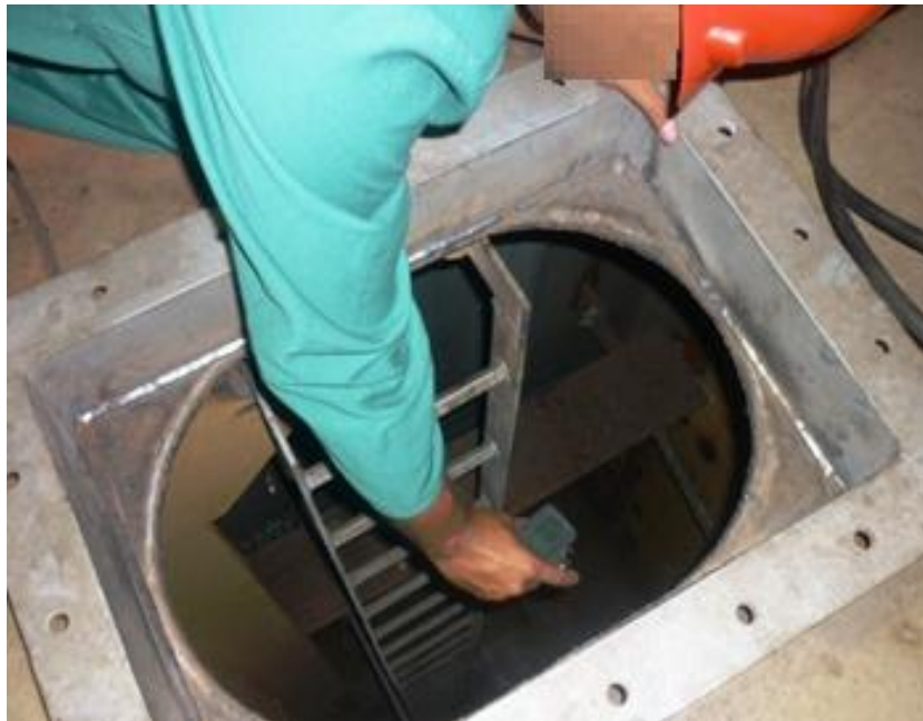
Foto 52 – Medição ambiental no espaço confinado. Fonte: o autor.
