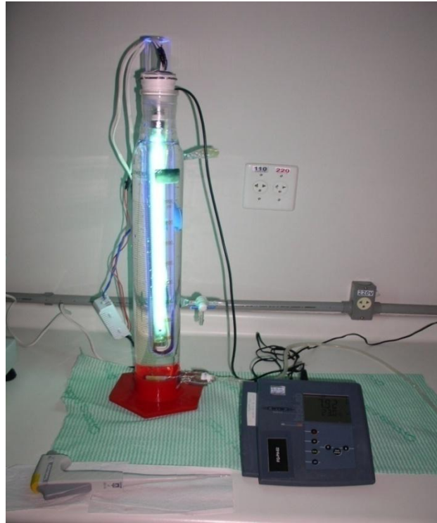
Figura 3.5.1. Foto do reator fotocatalítico utilizado nos experimentos.
