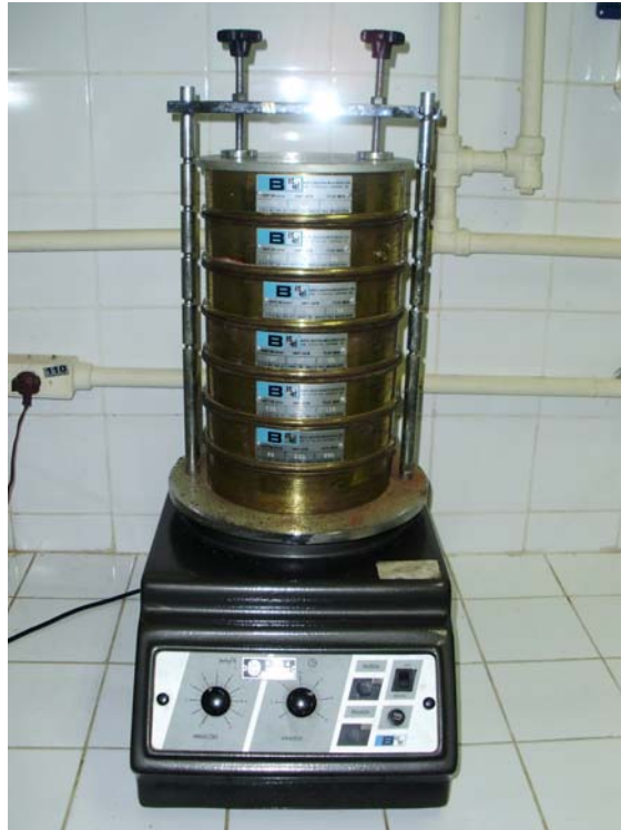
Figura 4: Conjunto de peneiras sobrepostas para a análise granulométrica do sedimento. Fonte própria.
