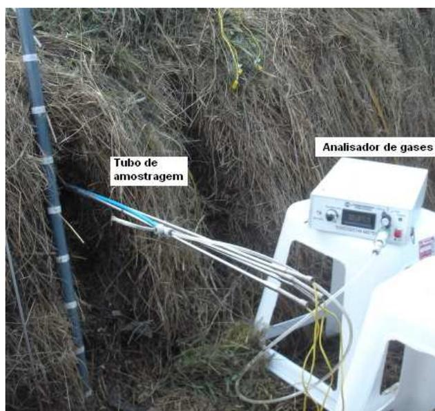
**Figura 17** – Detalhe da leitura das concentrações internas ( $O_2/CO_2/CH_4$ )
