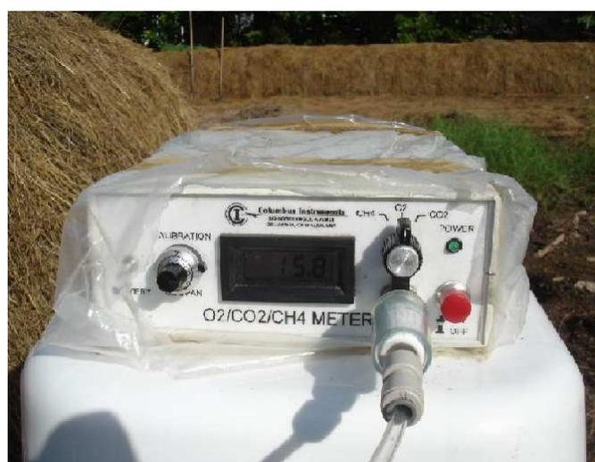
**Figura 21** – Analisador de gases  $\text{O}_2/\text{CO}_2/\text{CH}_4$  Columbus Instruments (Foto: Caio de Teves Inácio).
