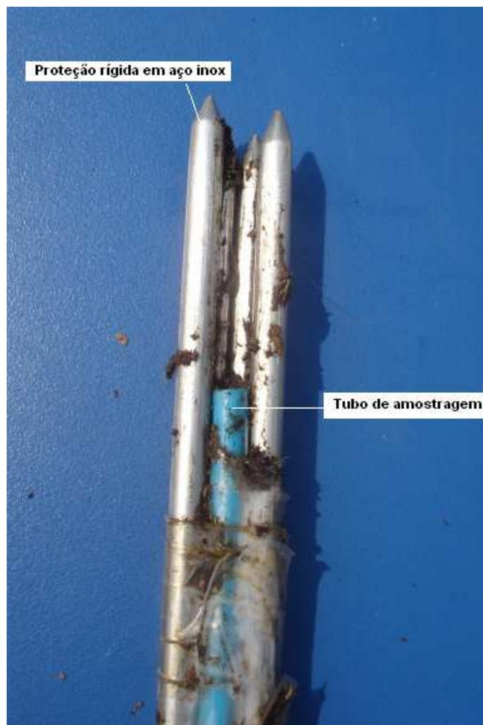
**Figura 19** – Detalhe da ponta do tubo de amostragem dos gases (Foto: Caio de Teves Inácio).
